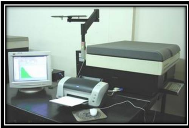
ပုံ (၁၀) Tritium ( ^3\text{H} ) ပါဝင်မှုကို တိုင်းတာနိုင်သော Liquid Scintillation Counter(LSC) နှင့် Enrichment System
